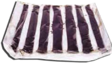
MÁSTICO BITUMINOSO EN CORDONES DE APLICACIÓN EN FRÍO. Junta-Fix frío es una masilla de sellado en frío formulada a partir de betún, plastificantes, cargas y elastómeros, presentado en forma de cordones de 50 cm. de longitud y diámetro 25 mm.
