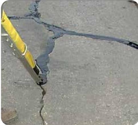
Es un mástico de betún modificado con SBS y carga mineral seleccionada especialmente formulado para realizar sellado de grietas y fisuras en pavimentos de aglomerado asfáltico y hormigón.
