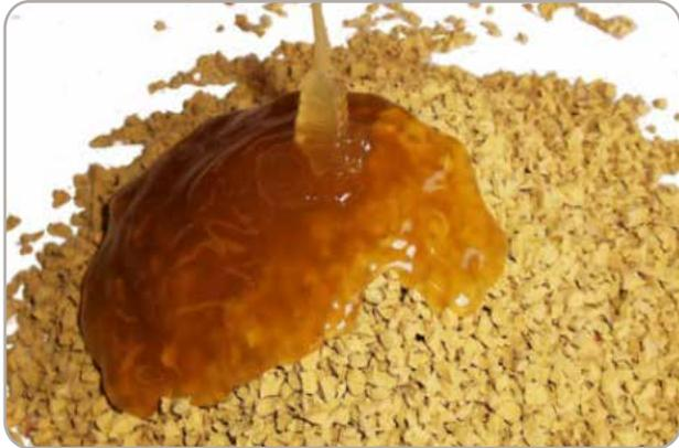
VULPUR son resinas de unión para aglomerar cauchos y EPDM para las distintas aplicaciones in situ. Hay dos tipos de resinas: alifática y aromática. Su uso dependerá del color que se quiera amalgamar.
