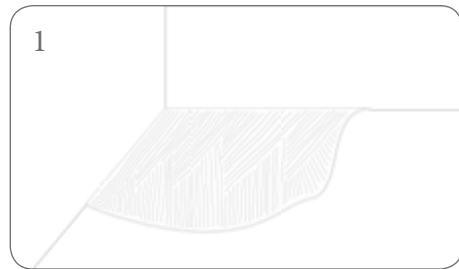
Aplicación del cemento cola. The application of adhesive. Application ciment colle. Auftragen des Fliesenklebers. Нанесение клея для плитки.
