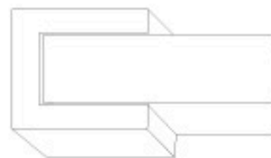
Soporte de pared - Guía superior compensación de 1 cm. por cada lado
