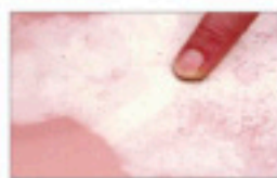
Efecto del depósito de cal en sustratos no tratados
