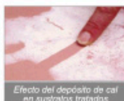
Efecto del depósito de cal en sustratos no tratados
