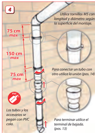
4. Instalar los collarines para tubería de distancia 150 cm. unos de otros y un máximo de 75 cm. al final del tubo. Al insertar el tubo bajante en el collarín, apriete el tornillo.
