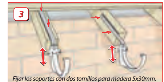
3. Para el montaje sobre vigas o techos planos se utilizan los soportes verticales u horizontales. Con la tuerca y tornillo M6 (pos.16) ajustar hasta la inclinación necesaria del canalón.
