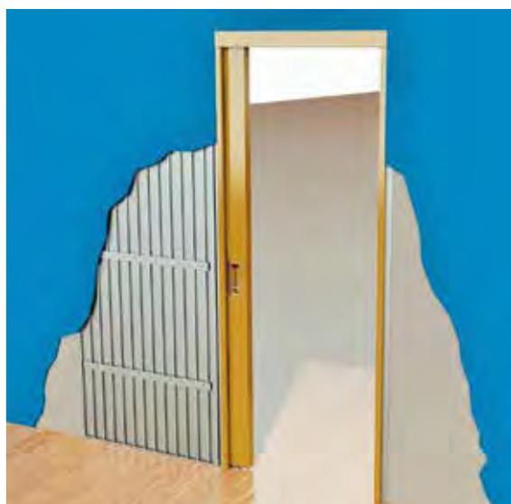
Ilustración de enlucido y remate. Ocultación del cajón.
