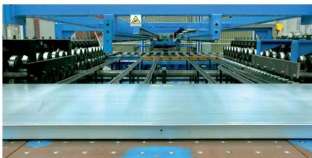
Línea automática de perfilado y ensamblado de puertas
