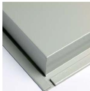
**Hoja:** Dos chapas de acero galvanizado unidas entre sí, con doble plegado y cosido. Aislamiento de lana de roca de 51 mm de espesor y alta densidad.
