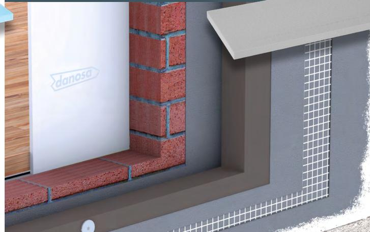
Máximo aislamiento con mínimo espesor
